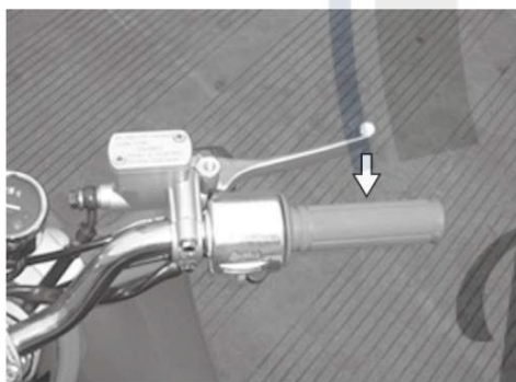
Bremshebel Vorderradbremse, gleichmäßig ziehen
